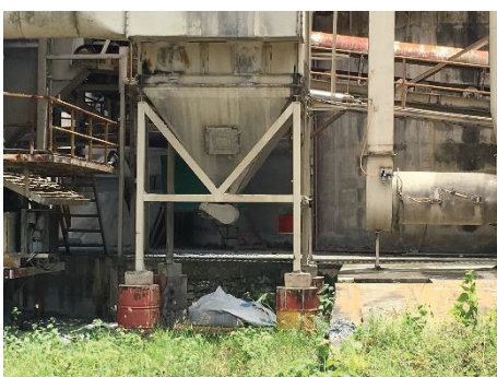
รูปที่ 2-7: การกำจัดฝุ่นแบบระบบถุงกรอง (Bag Filter) (ช่วงที่ตรวจสอบไม่มีการผลิตแร่)
